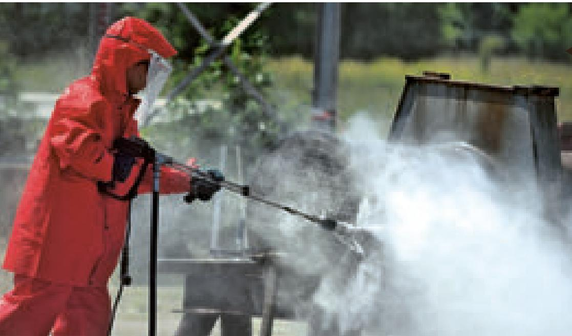
Manuelle Reinigung mit der handgeführten HD-Pistole. Hier muss der Industriereiniger dauerhaft einem Rückstoß von umgerechnet 15 Kilogramm entgegenwirken. Diese körperliche Belastung entfällt mit dem Roboter
